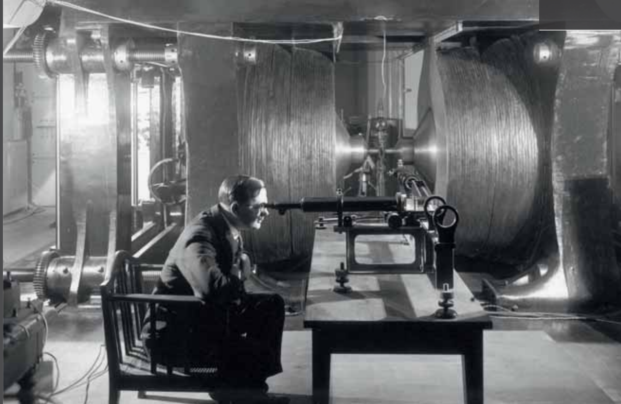
Expérience de spectroscopie à l'aide du grand électro-aimant, construit sous la direction d'Aimé Cotton et achevé en 1928.
