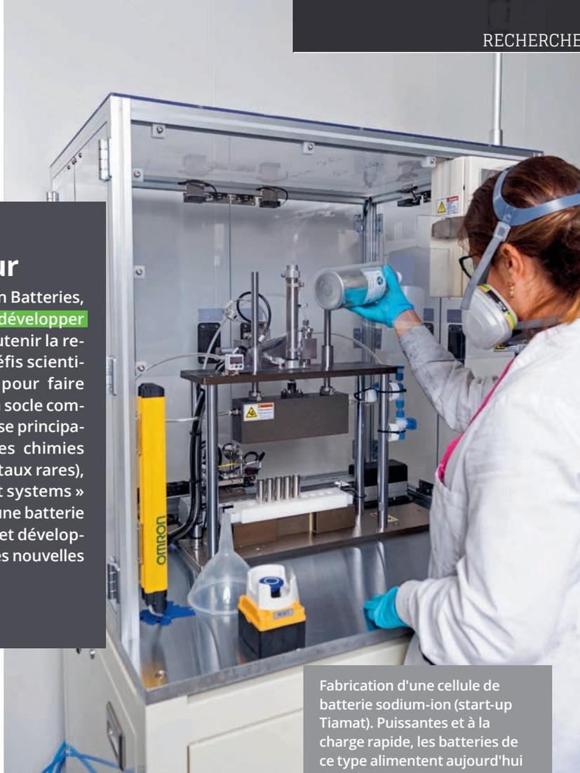
Fabrication d'une cellule de batterie sodium-ion (start-up Tiamat). Puissantes et à la charge rapide, les batteries de ce type alimentent aujourd'hui des véhicules électriques légers (scooters ou trottinettes).
