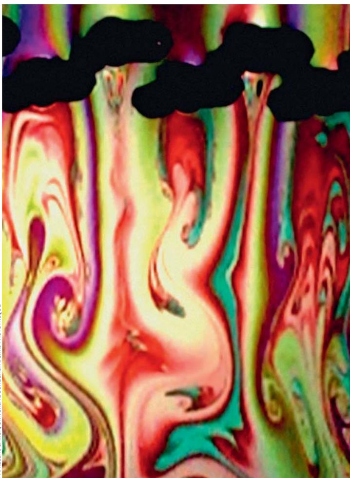
→ Pour vérifier leur théorie sur les turbulences, les chercheurs ont utilisé un film de savon tendu entre deux fils. Sur cette image, on voit que l'écoulement est perturbé par des cylindres (les points noirs en haut) qui engendrent des tourbillons.
