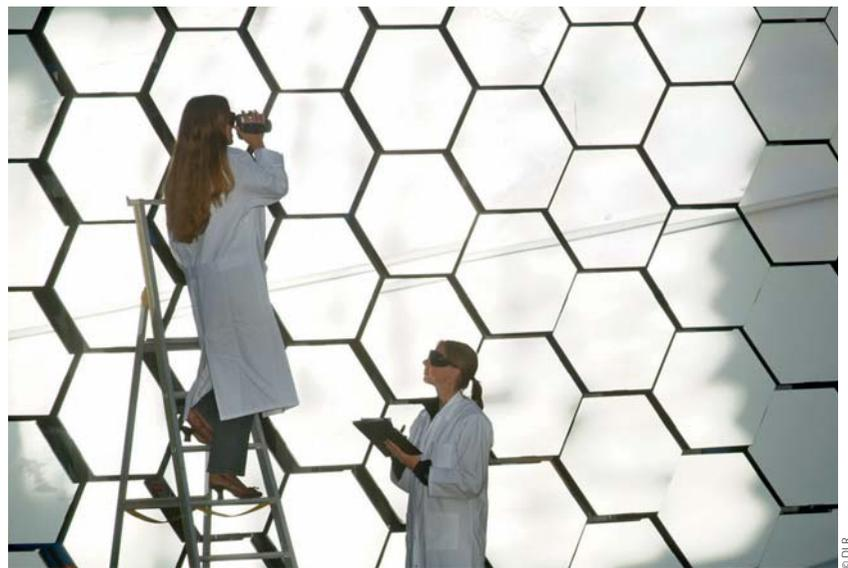
→ Vérification des 159 miroirs hexagonaux du four solaire du centre DLR, membre du GDRE SolLab, construit à Cologne, en Allemagne.
