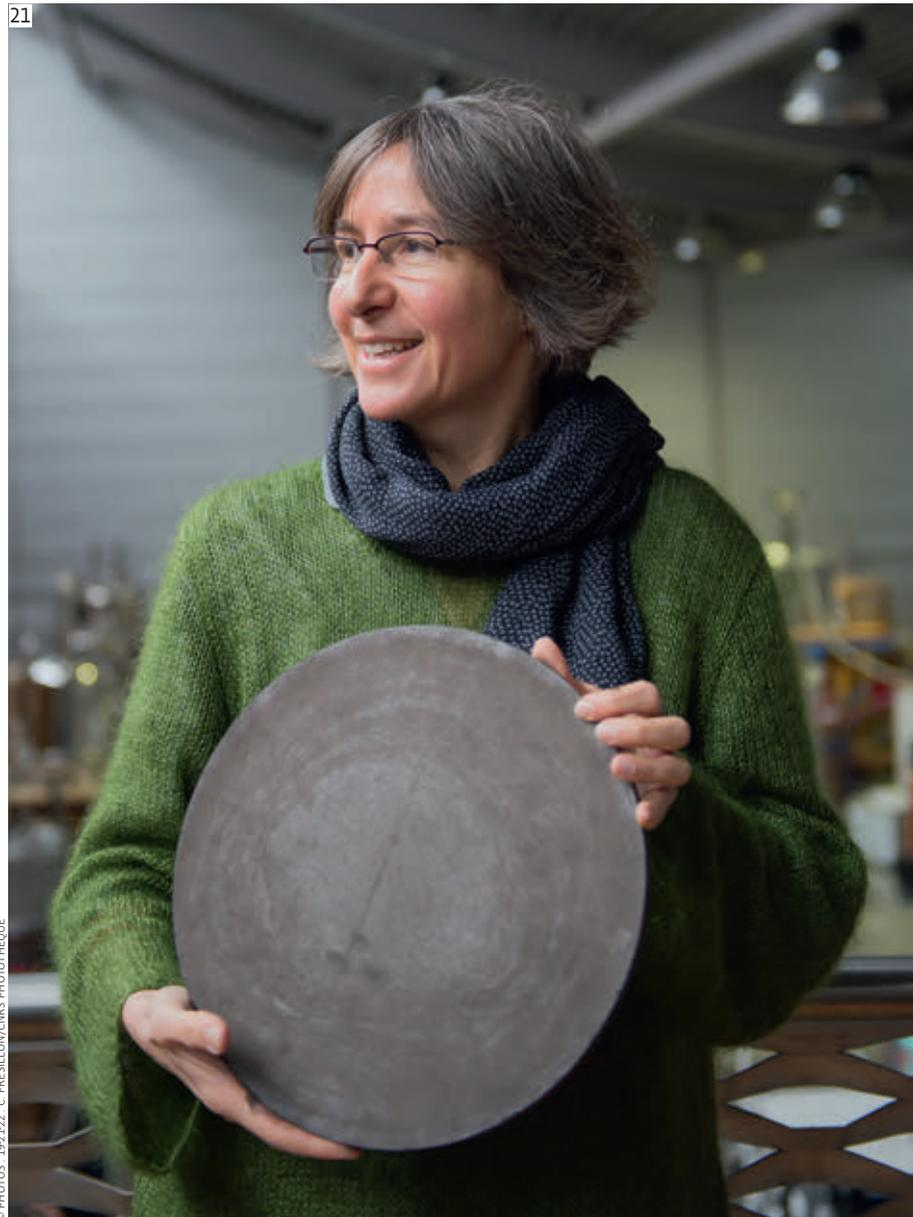
21 Ce disque élaboré par McPhy Energy contient 600 litres d'hydrogène. 22 Réservoir développé pour stocker l'hydrogène sous forme solide. Il permet d'absorber 7 000 litres d'hydrogène.
