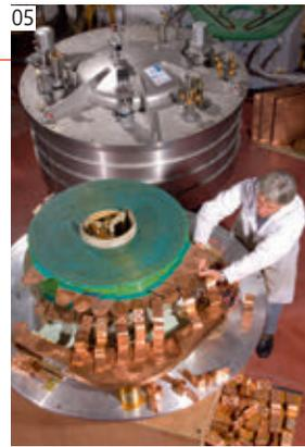
05 Bobine supraconductrice qui permet de stocker l'énergie sous forme d'un champ magnétique.
