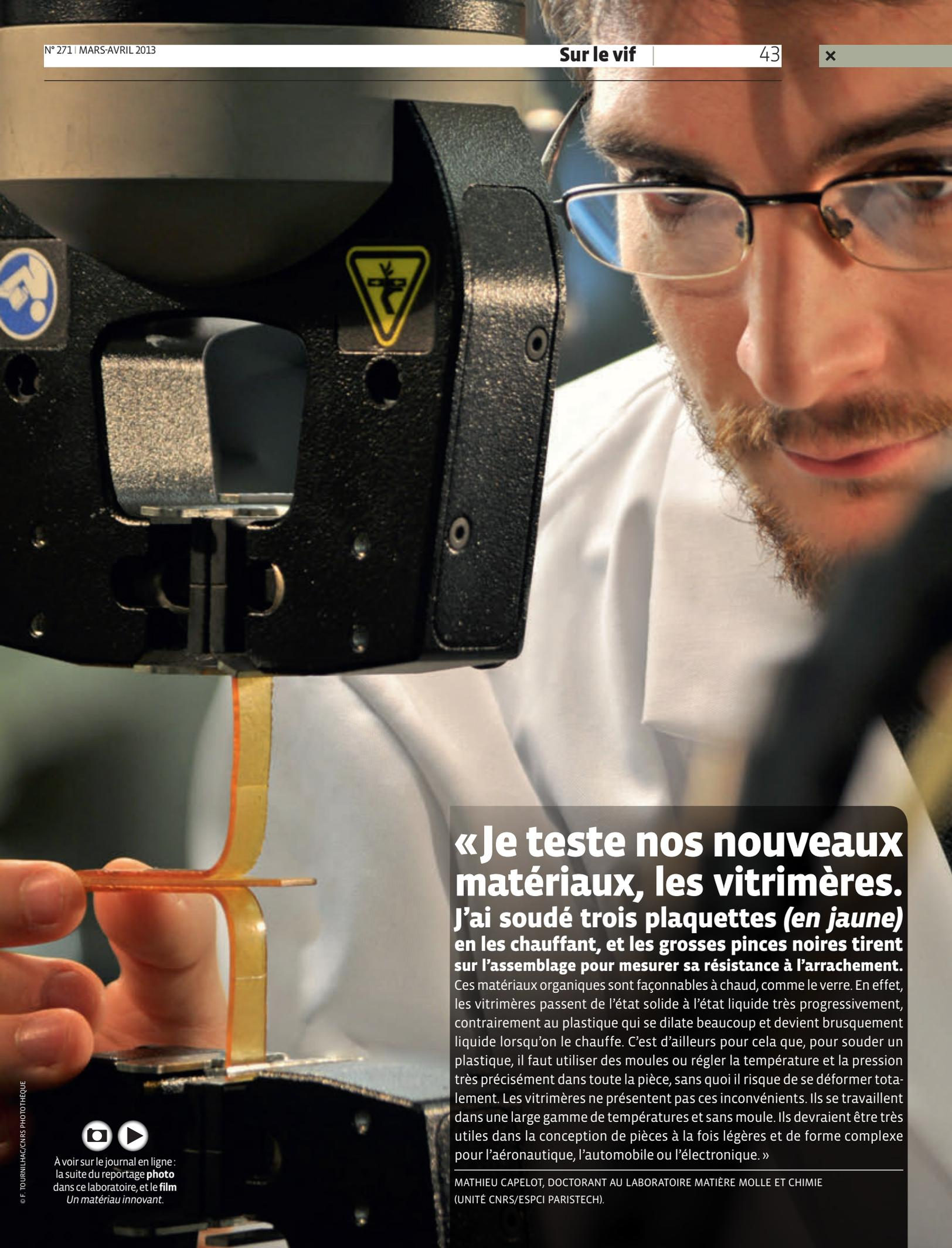
**« Je teste nos nouveaux matériaux, les vitrimères. J'ai soudé trois plaquettes (en jaune) en les chauffant, et les grosses pinces noires tirent sur l'assemblage pour mesurer sa résistance à l'arrachement. »**
