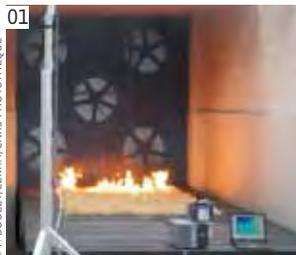
01 Les capteurs au premier plan analysent la propagation de ce feu, qui progresse en ligne sous l'influence d'un vent simulé par des ventilateurs.
