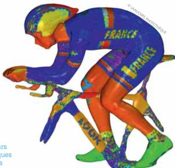
Les capteurs installés par les chercheurs fournissent des mesures aérodynamiques et une image de la position des athlètes sur leur vélo.
