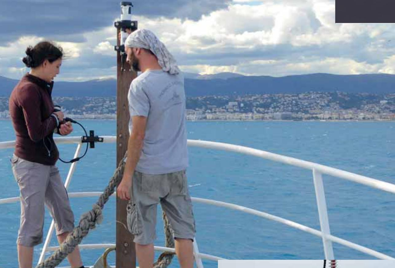
► Le radiomètre de surface, fixé à la proue du *Téthys*, permet de mesurer la quantité de lumière apportée par le soleil.
