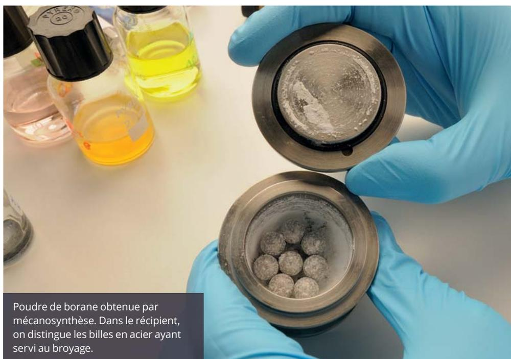
Poudre de borane obtenue par mécanosynthèse. Dans le récipient, on distingue les billes en acier ayant servi au broyage.
