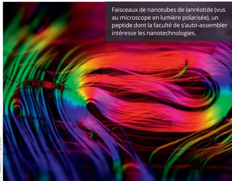
Faisceaux de nanotubes de lanthanéite (vus au microscope en lumière polarisée), un peptide dont la faculté de s'auto-assembler intéresse les nanotechnologies.
