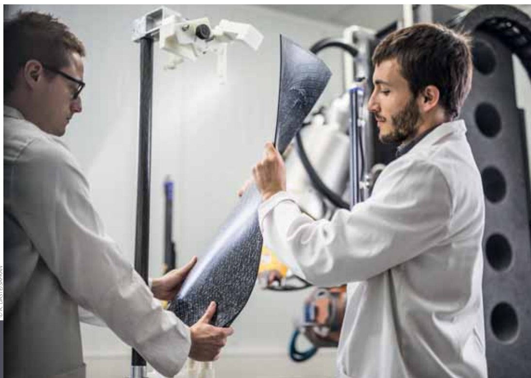
Le « plug ARCOCE », un cône d'éjection en composite à matrice céramique, a effectué son premier vol en 2015 sur un A320.
