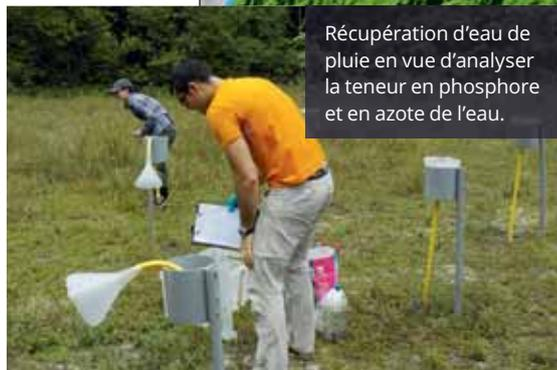
Récupération d'eau de pluie en vue d'analyser la teneur en phosphore et en azote de l'eau.
