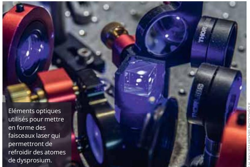
Éléments optiques utilisés pour mettre en forme des faisceaux laser qui permettront de refroidir des atomes de dysprosium.
