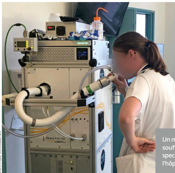
Un membre du personnel soignant souffle dans le tube de prélèvement du spectromètre de masse Vocus, à l'hôpital de la Croix-Rousse à Lyon.
