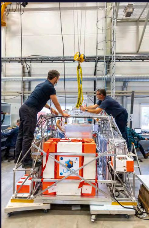
**3.** La nacelle, structure en aluminium faite sur mesure par le Cnes, dépasse à peine 512 kg, ce qui reste léger pour un ballon pouvant transporter 1,2 tonne jusque dans la stratosphère. Elle embarque 210 kg d'instruments de mesure des gaz à effet de serre.
