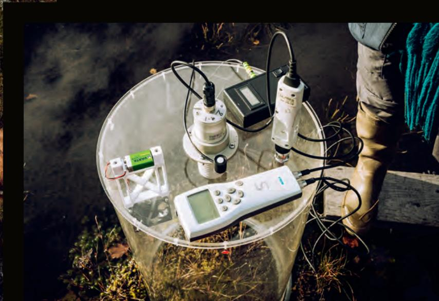
**9 et 10.** Ce cylindre de plastique est une chambre de mesure. Échanges gazeux, température, luminosité, tout y est pris en compte. Le dispositif permet ainsi d'évaluer le bilan entre la photosynthèse réalisée en pleine lumière par les plantes mises « sous cloche » et la respiration des plantes et micro-organismes du sol. C'est ce flux de carbone qui indique si, au point de mesure, le milieu fonctionne en source ou en puits de carbone.
