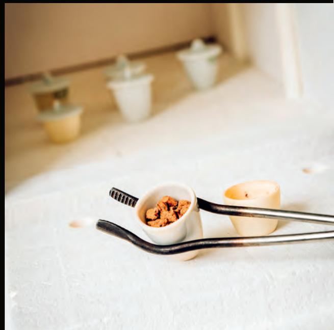
**8.** Les échantillons sont ensuite chauffés à 550 °C pendant quatre heures dans un four. Après cette procédure, dite « perte au feu », il ne reste plus de l'échantillon que la matière minérale qui permet d'évaluer le stock de carbone du sol. Les chercheurs suivent ainsi l'évolution de ce stock dont la baisse correspond à une moins bonne santé de la tourbière.
