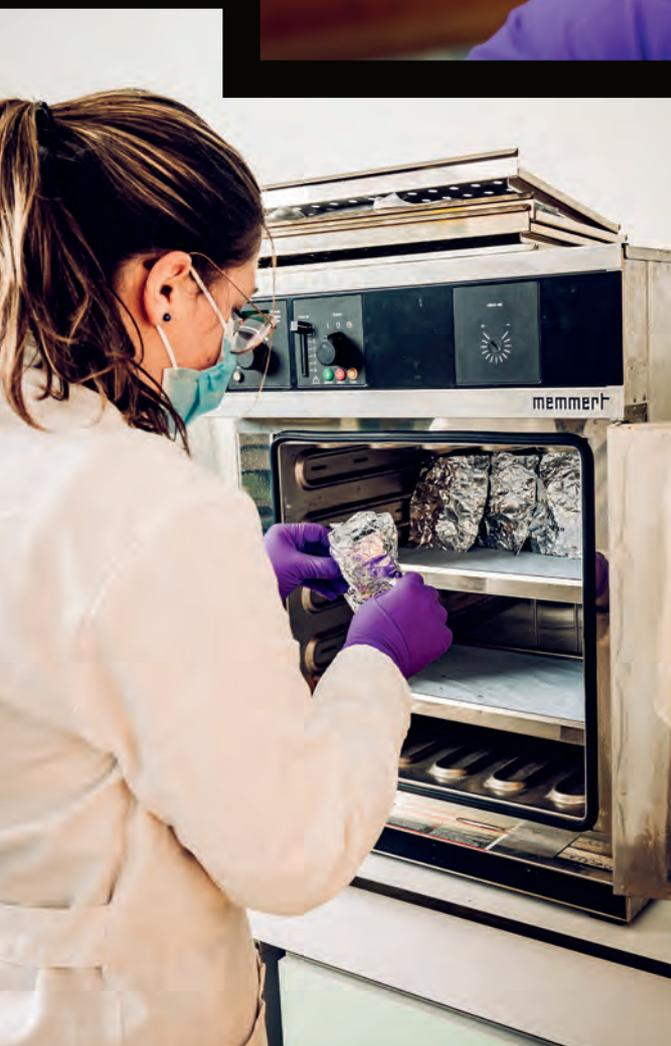
**6,7.** Les carottes sont conditionnées en tranches dans des feuilles en aluminium (en haut) pour éviter les contaminations extérieures. Après les avoir pesés, les échantillons sont séchés à 40 °C dans une étuve pendant une semaine (à gauche). Puis, ils sont à nouveau pesés. La différence de masse permettra de modéliser la teneur en eau des tourbes.
