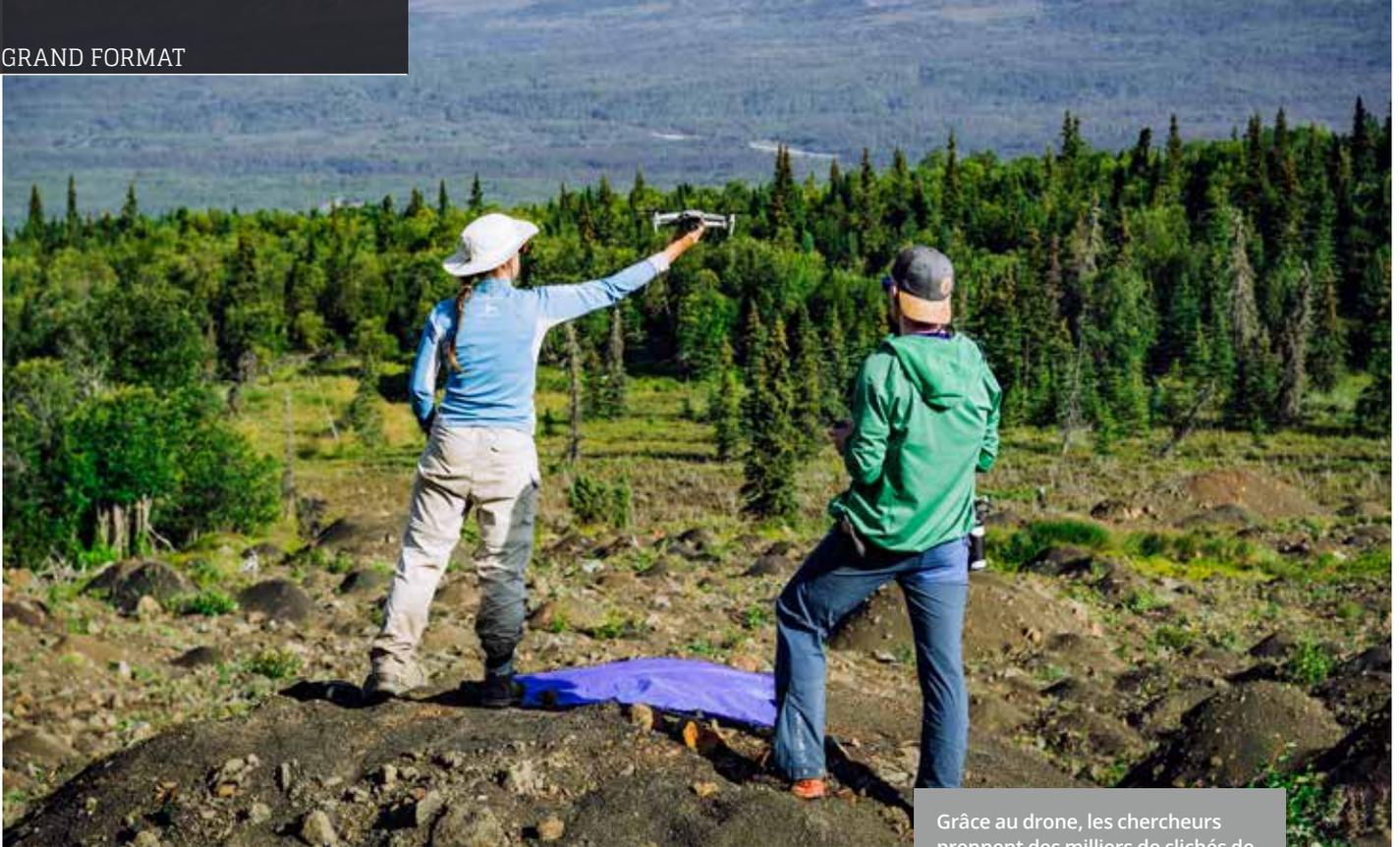
Grâce au drone, les chercheurs prennent des milliers de clichés de la zone. Cette technique, appelée photogrammétrie, leur permettra de produire un modèle en 3D de tous les molards.
