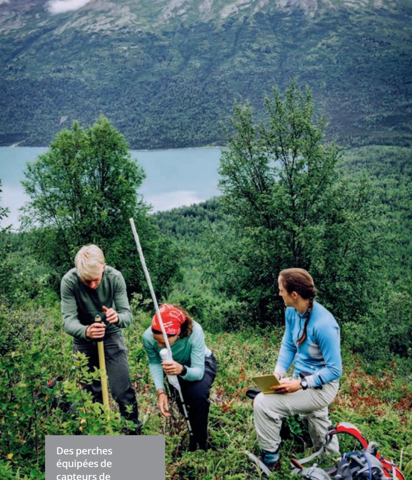
Des perches équipées de capteurs de température sont plantées dans le sol à différentes altitudes.
