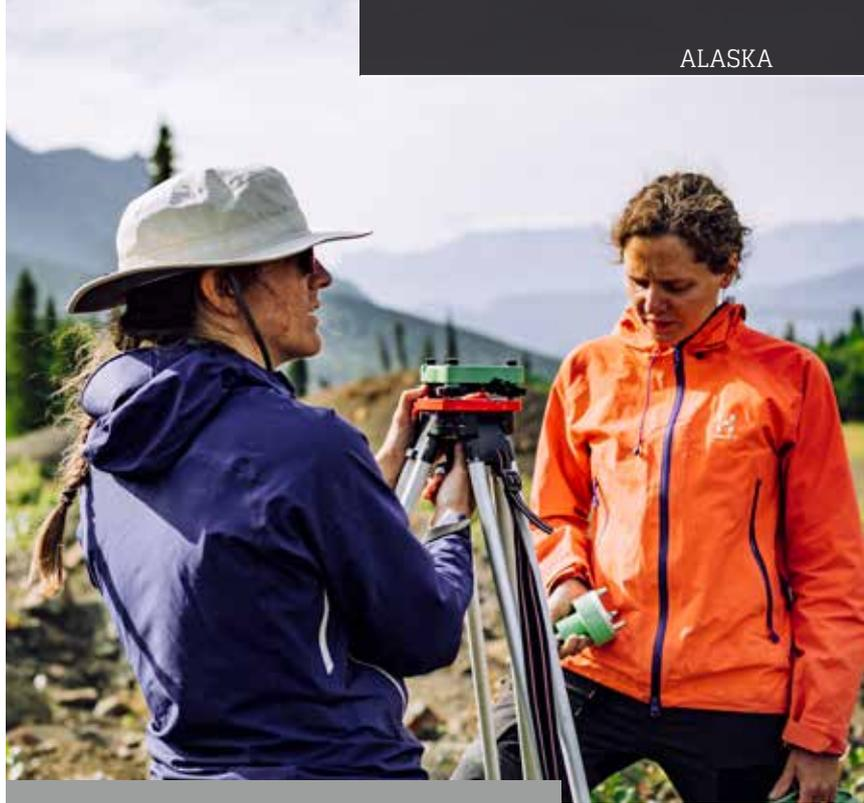
Installation d'une station GPS fixe au campement. Couplée au GPS mobile, elle permettra de déterminer avec précision la position et la taille des molards.
